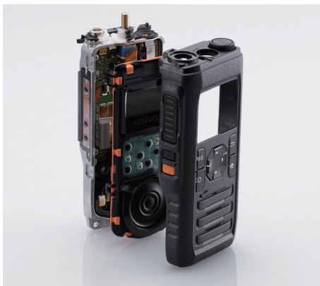
防塵/防水/衝撃/歪に強い2重構造
