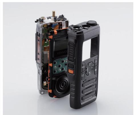
防塵/防水/衝撃/歪に強い2重構造
